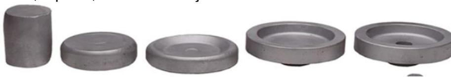
Figura 1 - Sequência de fabricação de peças vazadas a partir de billet maciço.
