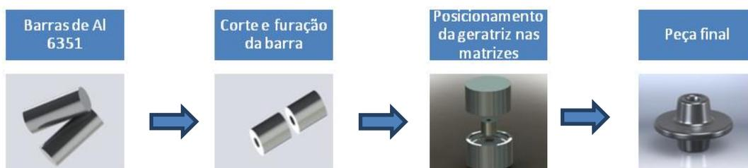
Figura 9 - Sequência de forjamento experimental.
